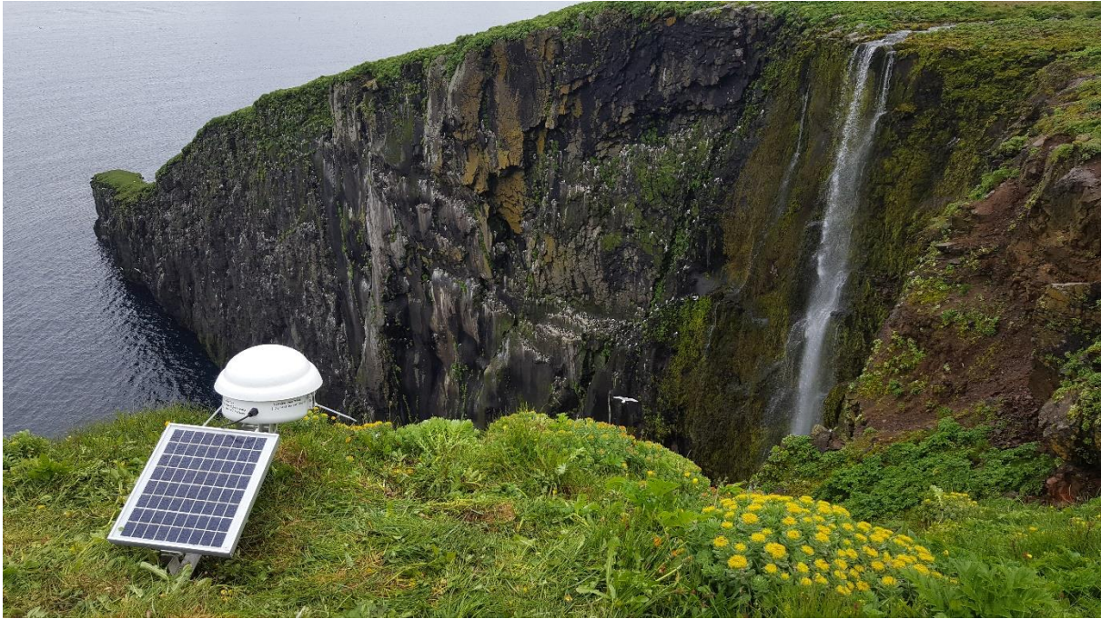
3. mynd. Vöktunarmyndavél af „Cyclapse“ gerð frá Harbortronics horfir yfir hluta Langakambs í Hælavíkurbjargi. Sólarrafhlaða sér um að halda búnaðinum gangandi árið um kring. Ljósmyndin er tekin þegar vélin var sett þar upp í fyrsta skipti 3. júlí 2017.
